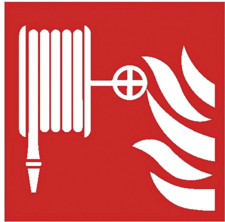
Abb. 17: Brandschutzzeichen F002 „Löschschlauch“ auch Wandhydrant genannt.
