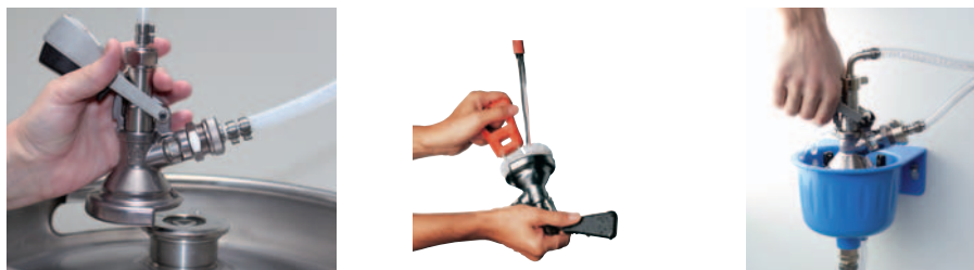
Abb. 3: links: kritischer Bereich (Anschluss des Zapfkopfs an den Getränkebehälter), Mitte: Reinigung des Zapfkopfes mit Trinkwasser und Bürste, rechts: Reinigung des Zapfkopfes mit einer Zapfkopfdu-sche Spülen des Hahnauslaufes und der Luftbohrung mittels Reinigungsball
