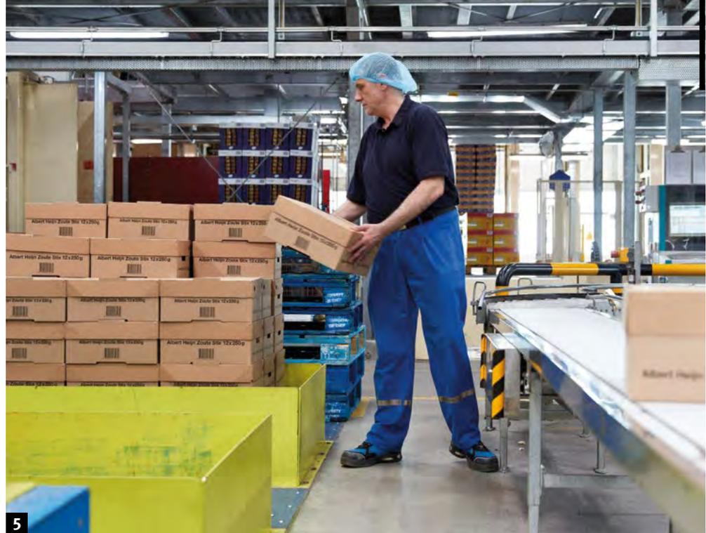
größe bei körperlicher Arbeit – so auch hier. Um die Belastungen am Arbeitsplatz zu reduzieren, hat das Unternehmen auf Basis der Gefährdungsbeurteilung folgende Sofortmaßnahmen umgesetzt: Die Höhe des Auslaufbandes wurde auf circa 85 cm erhöht. Zusätzlich wurde ein Scherenhubtisch zum Palettieren zur Verfügung gestellt. Weiterführende Maßnahmen, auch organisatorischer Art, wird das Unternehmen darüber hinaus prüfen.
