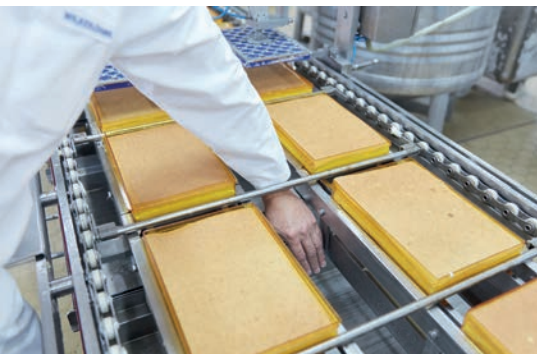
Tritt durch eine hineingreifende Hand ein Widerstand auf, hebt sich der Mitnehmerstab aus der Halterung und springt heraus.
