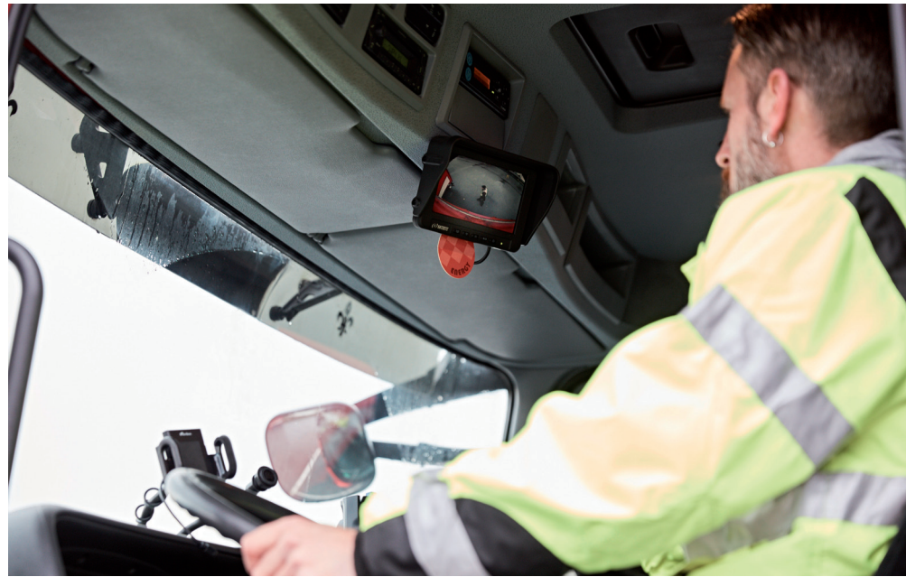
Den Raum hinter dem Lkw erfasst die Heckkamera, der Fahrer sieht den Fußgänger auf dem Bildschirm.
